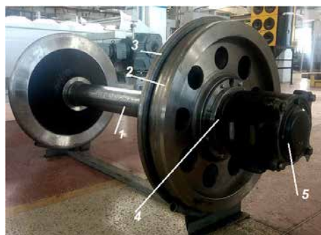
Рис. 1. Блочная колесная пара 1 – типовая ось колесной пары; 2 – колесо с поверхностью катания; 3 – дисковый гребень; 4 – подшипники колеса; 5 – типовая букса колесной пары
