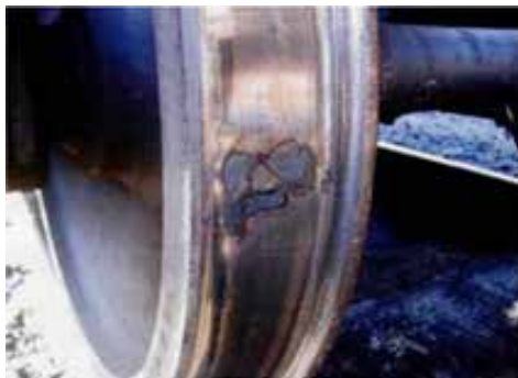
Рис. 2. Дефекты бандажа колесной пары электровозов 2ЭС6
