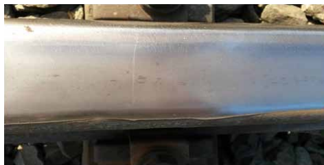
Рис. 1. Термомеханические повреждения головки рельса из-за боксования колес электровоза
