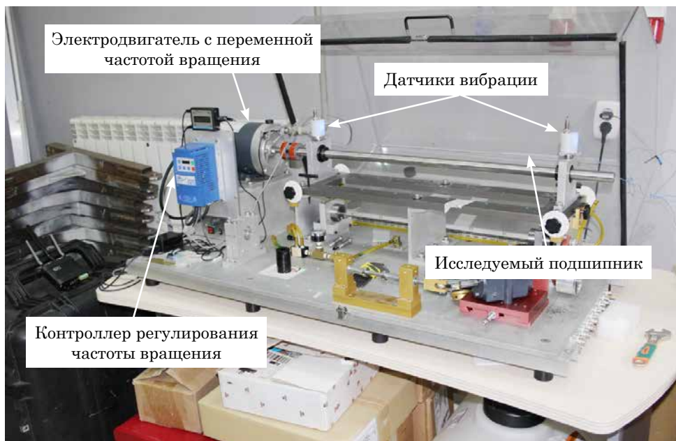
Рис. 3. Стенд Spectra Quest Fault Simulator Setup вибродиагностики подшипников качения
