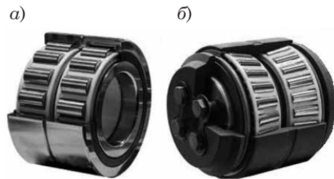
Рис. 1. Подшипники железнодорожного подвижного состава а – цилиндрические подшипники в корпусе буксы грузовых вагонов (цилиндрический роликовый блок, CRU); б – касетный подшипник под адаптер (компактный конический роликовый блок, СТБУ)
