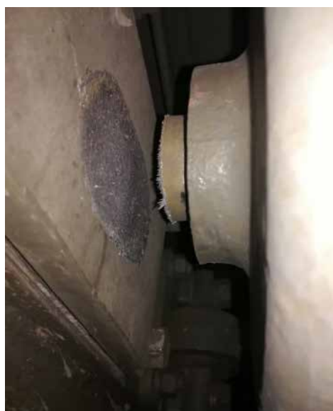
Рис. 3. Износ поверхностей пальца упора и упорной плиты
