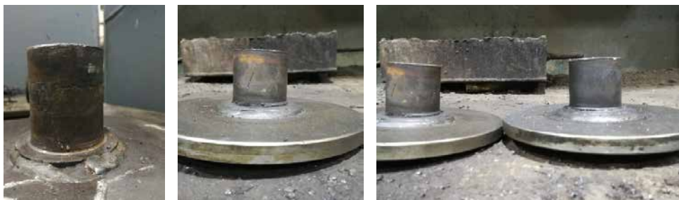
Рис. 5. Износ упоров в эксплуатации
