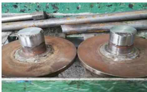
Рис. 5. Износ упоров в эксплуатации
