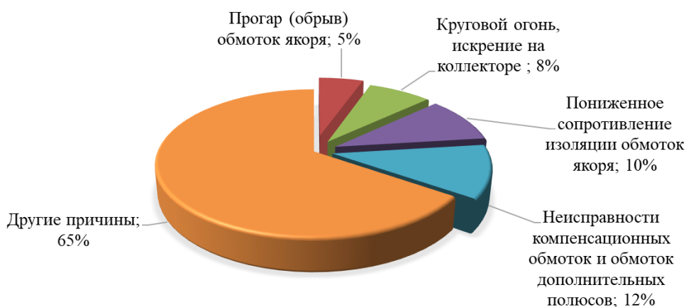
Рис. 1. Причины возникновения неисправностей тяговых электродвигателей электровозов 2ЭС6
