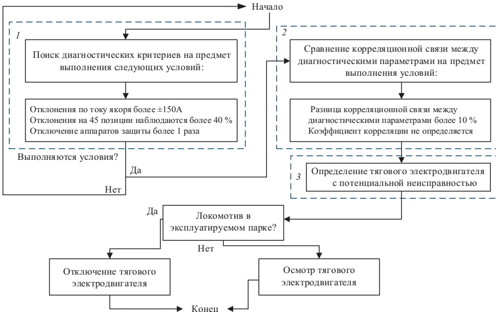
Рис. 2. Алгоритм определения технического состояния тяговых электродвигателей электровозов 2ЭС6
