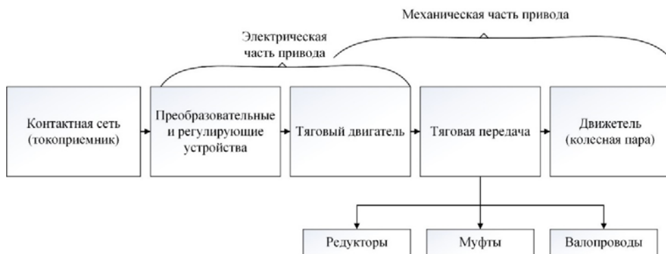
Рис. 1. Структурная схема тягового привода
