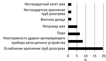
Рис. 3. Повреждения вагонов-цистерн в эксплуатации
