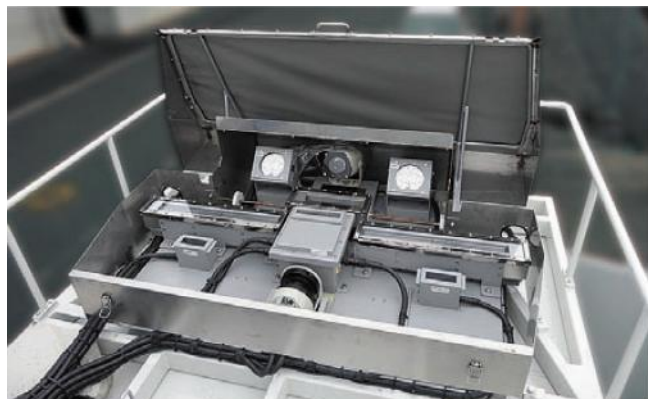
Рис. 2. Размещение тепловизионного оборудования на крыше электроподвижного состава:
