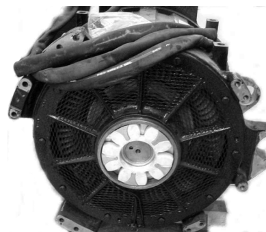
Рис. 4. Вид упругой муфты привода Ансальдо Бреда
