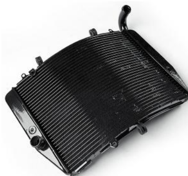
Рис. 4. Радиатор 1-го типа, модель Honda CBR 600
