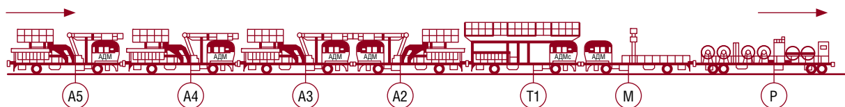
Рис. 9. Схема монтажного комплекса контактной сети КС-400:
