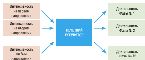
Рис. 2. Блок-схема нечеткого регулятора для метода предварительного расчета
