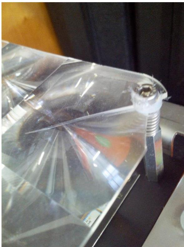
Рисунок 3.3 - Пример неоптимальной конструкции линзы с механическими повреждениями.
