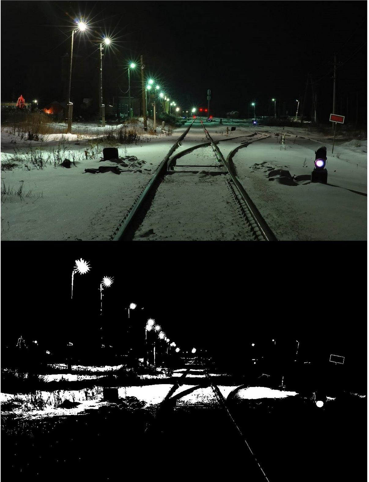
Рисунок 4.8 - Изображения реальное и обработанное путей ночью в зимнее время при наличии паразитной засветки.
