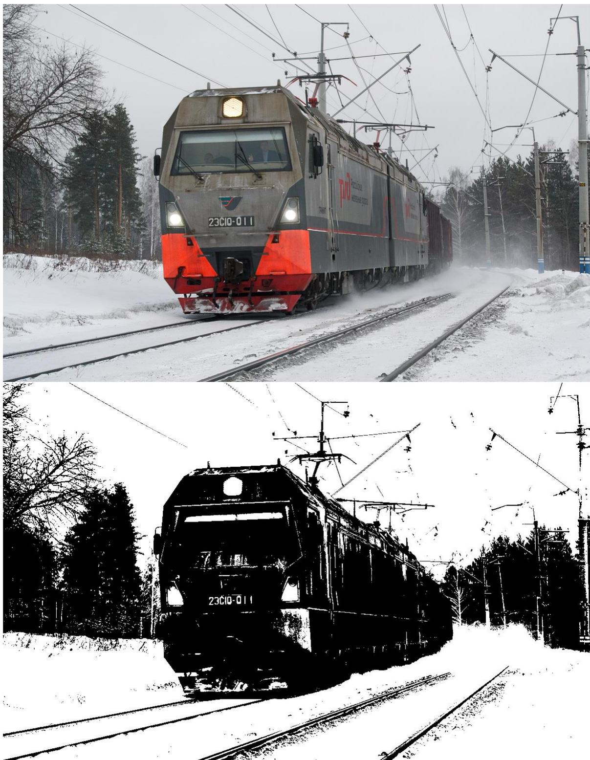
Рисунок 4.10 - Изображения реальное и обработанное путей и встречного состава с включенными световыми сигналами днем в зимнее время при отсутствии паразитной засветки.
