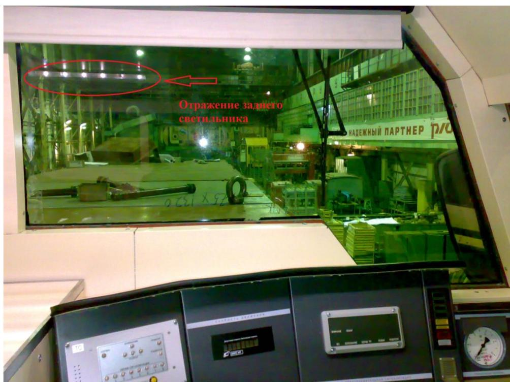
Рисунок 2.9 - Отражение от светильников в лобовом стекле при положении машинистов стоя
