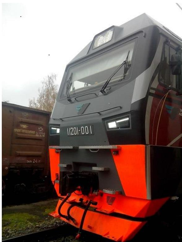
Рисунок 3.19 - Вид прожектора локомотива со светодиодными излучателями
