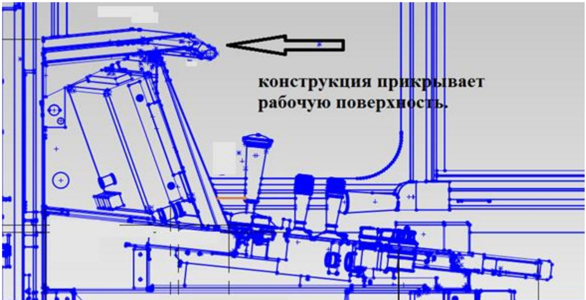
Рисунок 2.2 - Продольный разрез пульта управления
