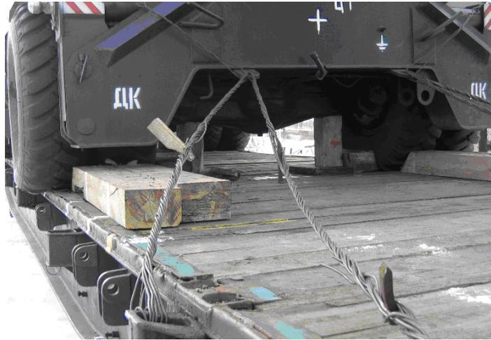
Рисунок 1.9 – Ослабление и провисание растяжек автомобиля
