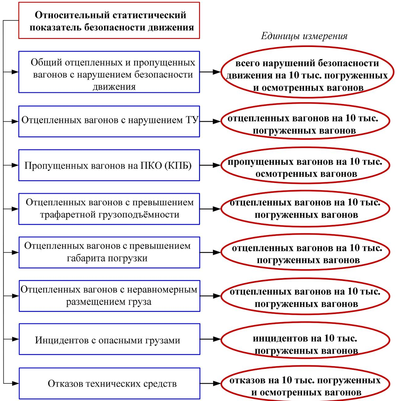
Рисунок 1.2 – Характеристика относительного статистического показателя безопасности движения
