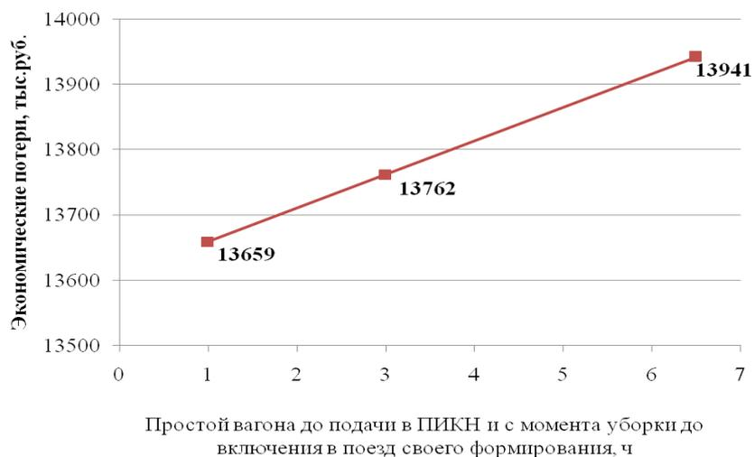
Рисунок 4.11 – Зависимость экономических потерь ОАО «РЖД» от простоев вагонов до подачи в ПИКН и после выхода из них
