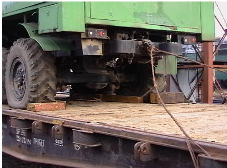
Рисунок 1.10 – Деформирование шин автомобиля и провисание растяжек
