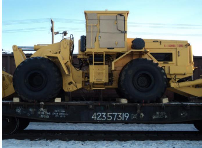
Рисунок 1.7 – Вагон с погрузчиком, отцепленный на ПКО для исправления коммерческих неисправностей
