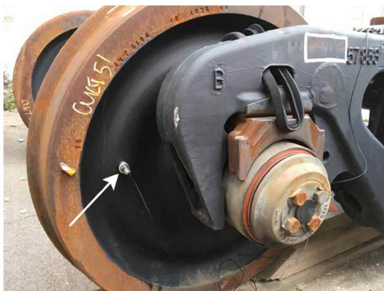
Рис. 1. Установка акселерометра на диске колеса
