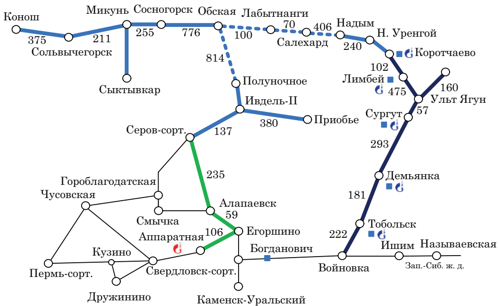
Рис. 4. Размещение экипировочных пунктов для дозаправки газотурбировозов Г – действующий комплекс по производству СПГ; Г – необходимые комплексы по производству СПГ; ■ – пункты экипировки СПГ
