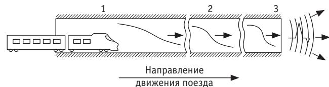
**Рис. 10. Схема образования волн микродавления:**
