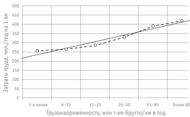
Рис. 2. График зависимостей фактических затрат труда работников, занятых на текущем содержании стрелочного перевода, от грузонапряженности
