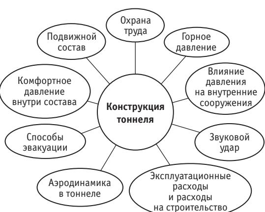
Рис. 3. Связь аспектов при проектировании тоннеля
