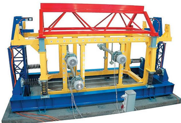
Рис. 1. Общий вид вибростенда и размещение вибровозбудителей
