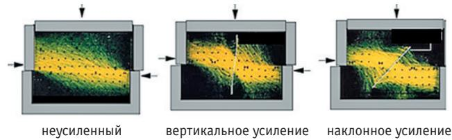
Рис. 2. Результаты испытаний армированных образцов методом фотоупругости [8]
