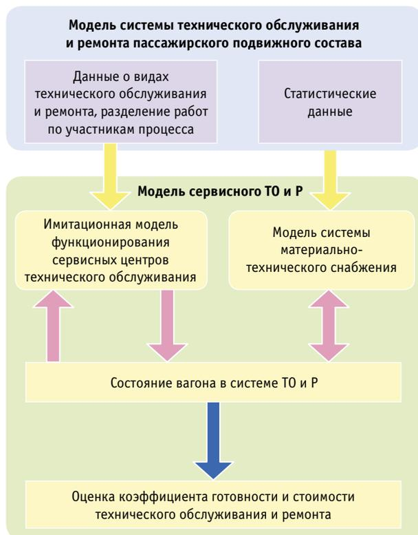
Рис. 1. Структура модели сервисного технического обслуживания и ремонта пассажирского подвижного состава
