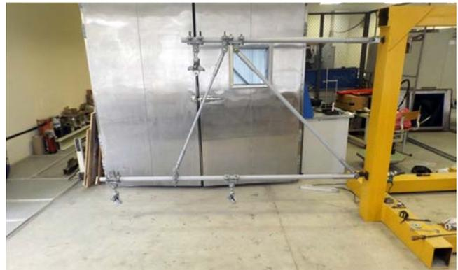
Рис. 4. Кронштейн КПВЛТ, закрепленный на раме
