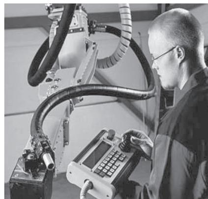
Рис. 1. Дробеструйная установка очистки кузовов подвижного состава с промышленным роботом Blastman B20
