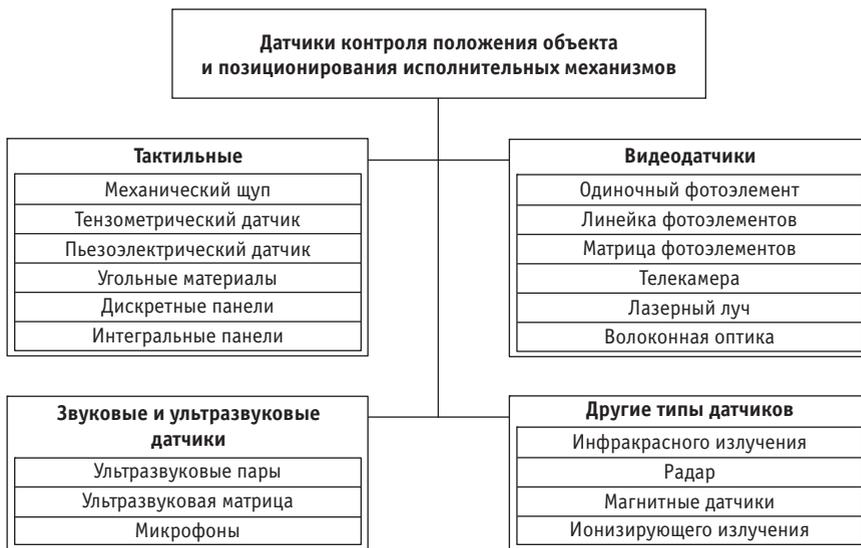
Рис. 3. Классификация датчиков роботизированных комплексов
