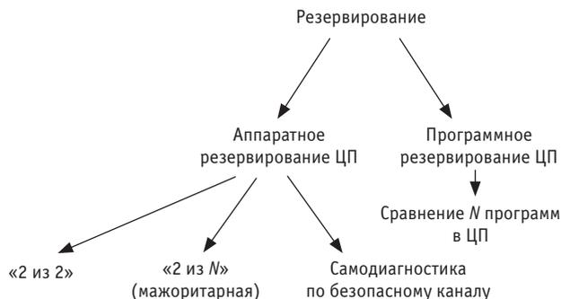
Рис. 5. Классификация безопасных структур систем ЦП МПЦ
